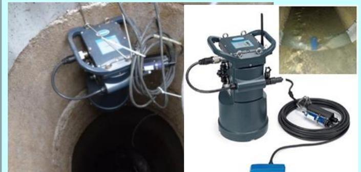
Caudalímetro de alcantarillado abierto
